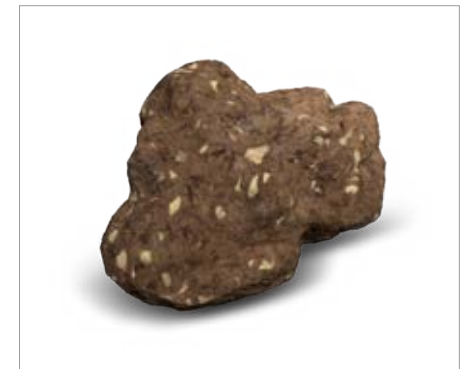
Das Infill Fusion GT besteht aus hochentwickelten Kunststoff-Granulaten kombiniert mit dem natürlichen Rohstoff Hanf.
