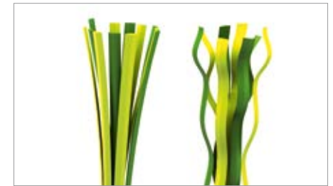
Vergleich von glatten und texturierten Filamenten
